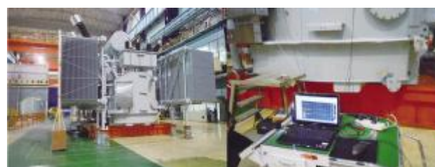
图11 变压器振动和噪声测试现场
